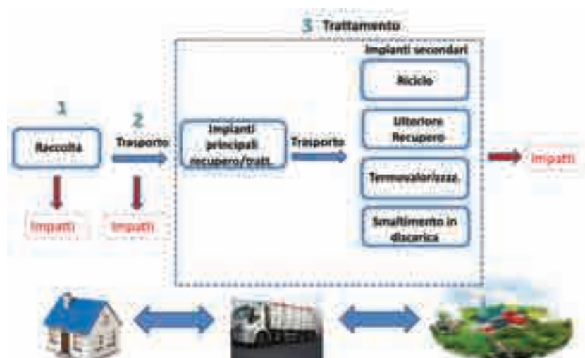
Figura 1: Schema delle fasi prese in esame dallo studio di LCA: raccolta, trasporto a impianti di selezione/trattamento (impianti primari), successivo recupero/trattamento/smaltimento presso ulteriori impianti (impianti secondari).
